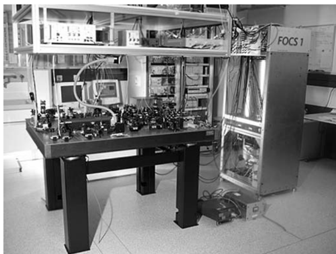
Orologio atomico al cesio costruito nel 2004 per un laboratorio svizzero che opera con un'incertezza di 1 secondo ogni 30 milioni di anni.
